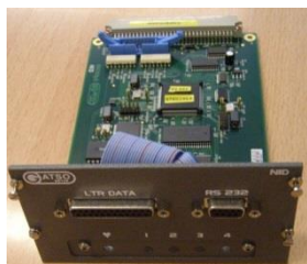
Slika 6. Modul NID i planarna Dopplerova antena LTR
